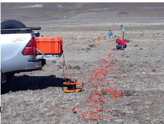
Ejecución perfil geoelectrico
