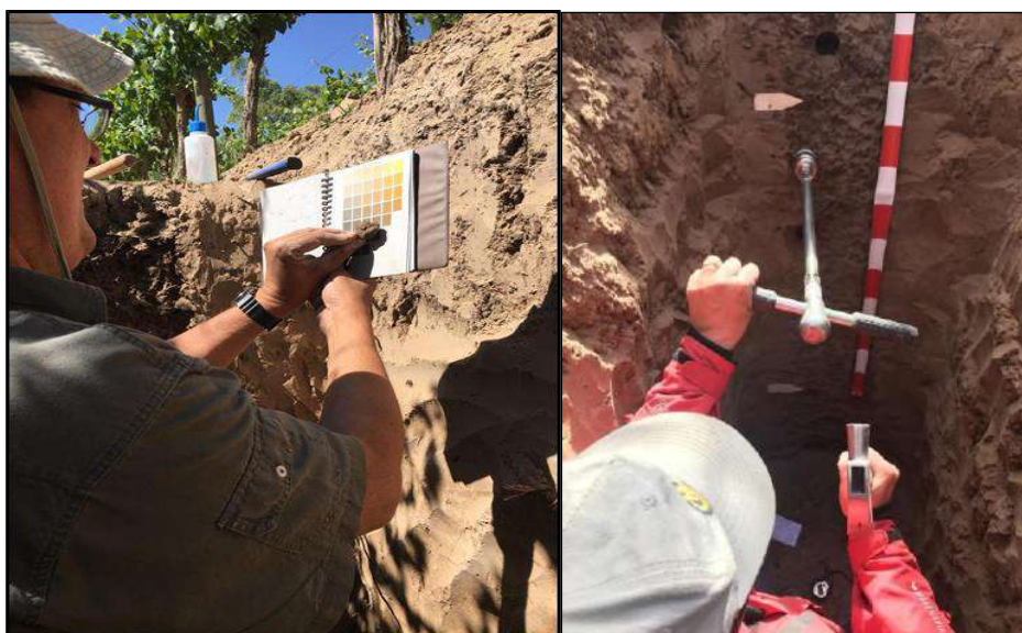
Figura 38 . Determinación del color del suelo con la Tabla de Munsell (IZQ) y extracción de muestras de suelo no alteradas con penetrómetro (DER). Fuente de archivo: Babelis, G.
