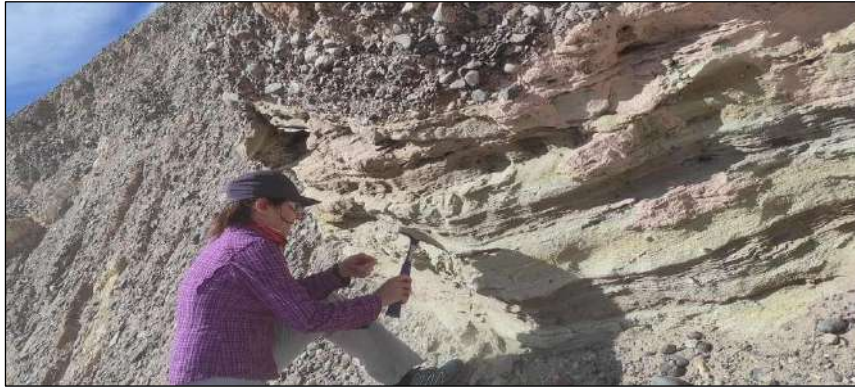
Figura 32 . Conteo de bloques en el caso de suelos gruesos para determinar la composición litológica en los suelos. Subzona Tinogasta
