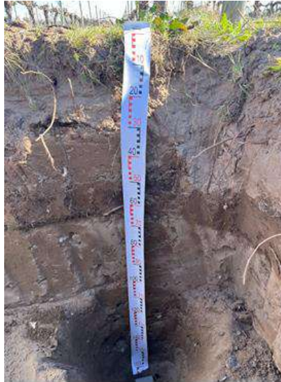
Figura 58. Sedimentos fluviales con predominio de arenas, gravas y limos en menor proporción.
