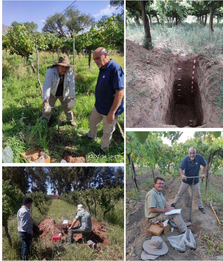
Figura 19 Descripción de perfiles de suelo mediante calicatas y barrenados Va. del Bermejo (febrero 2023). Fotos: Babelis, G.
