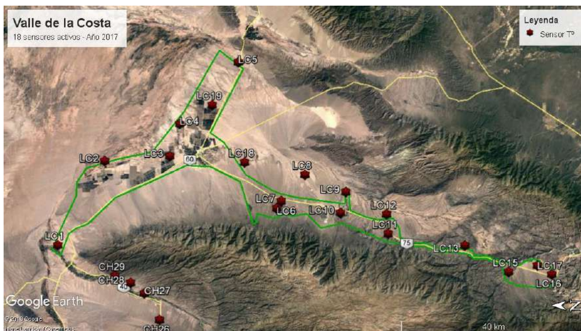
Figura 9. Posición real de los sensores de la zona de La Costal: los iconos rojos indican la posición geográfica real de los sensores.
