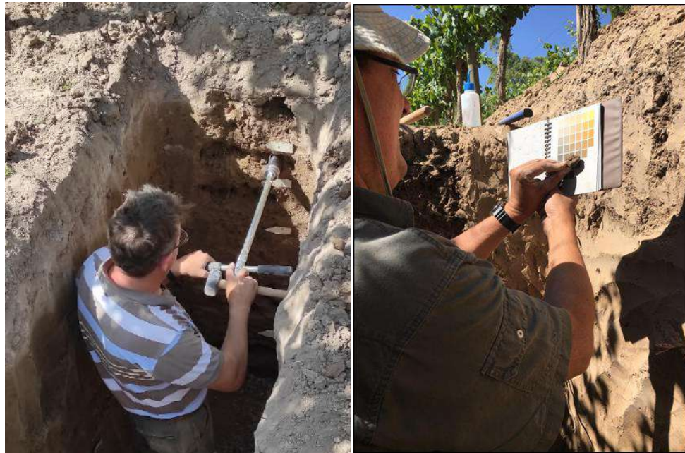
Figura 21 Toma de muestra con equipo de PEA y lectura de color de suelos Tabla de Munsell (Fuente. Babelis, G.).
