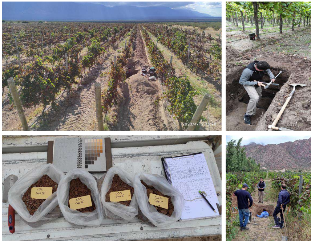
Figura 20 Descripción de perfiles de suelo mediante calicatas Va. de Chilecito y Va de la Costa (abril 2023). Fotos: Babelis, G.
