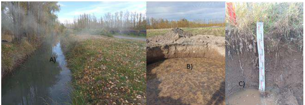
Figura 56. Bodega Chacra: A) Arroyo que rodea a la bodega. B) calicata inundada. C) Profundidad a la que ascendió la freática.
