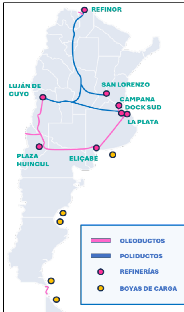
Figura 10. Esquema de infraestructura de transporte y refinación de petróleo.
